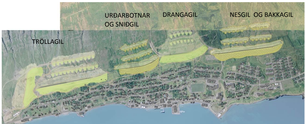
Mynd 1 - Frumathugunin er unnin fyrir tvö svæði, Urðabotna og Nes- og Bakkagil. Nú þegar eru risin varnarvirki undir Drangagili og Tröllagili.
